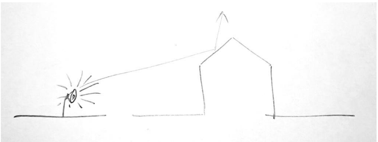
Figuur a. Zadeldaken kaatsen het geluid grotendeels omhoog
